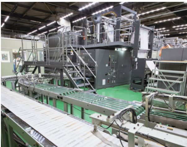
A横全判、B縦半裁輪転機等、三菱製輪転機が4台並ぶ商業オフセット輪転機のエリア
