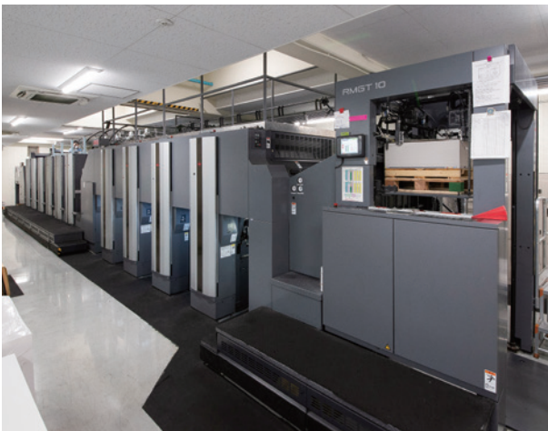
三菱が業界に先駆けて開発した片啜え方式タンデムパーフェクター
